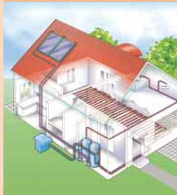
Luft-Wasser-Wärmepumpe mit Solareinbindung in der Außenaufstellung.
