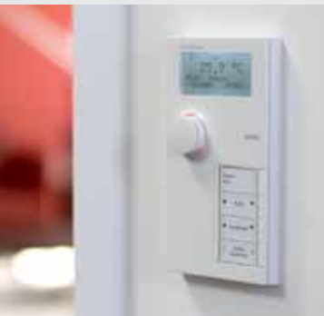
Zentrale Bedieneinheit für z. B. Leuchten, Jalousien, Heizung
